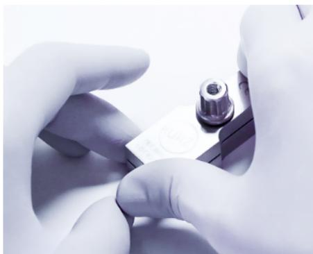
2. Ruotare la sezione superiore del blocco di taglio finché non è allineata con quella inferiore. Serrare il dado per fissare il blocco di taglio in questa posizione.
