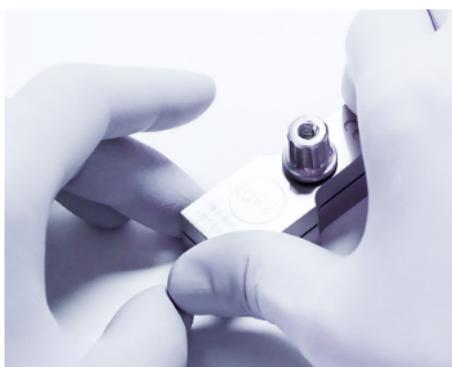
4. Ruotare la sezione superiore del blocco di taglio finché non è allineata con quella inferiore. Serrare il dado per fissare il blocco di taglio in questa posizione e comprimere la fascia.
