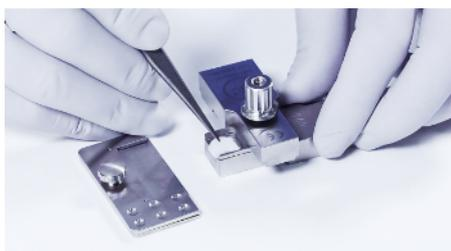
4. Rimuovere la lama. Il preparato di cartilagine con uno spessore definito si trova sulla sezione inferiore del blocco di taglio. Rimuovere il preparato di cartilagine con l'ausilio di una pinza.
