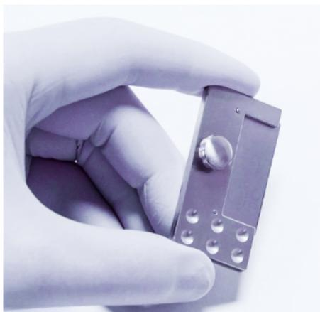
4. Posizionare la parte del portalama senza pin (sezione 2) sulla sezione 1 e sulla lama.
