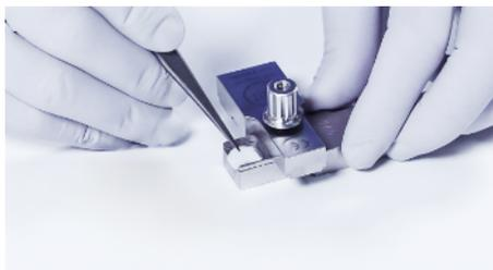
5. Posizionare il blocco di taglio, allentare il dado e ruotare la sezione superiore del blocco di 90°.
