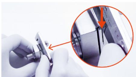
1. Inserire la lama nella guida nella sezione inferiore e tagliare la cartilagine con movimenti in avanti e indietro. Lasciare inizialmente la lama nella guida.
