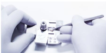
2. Posizionare il blocco di taglio, allentare il dado e ruotare la sezione superiore del blocco di 90°.
